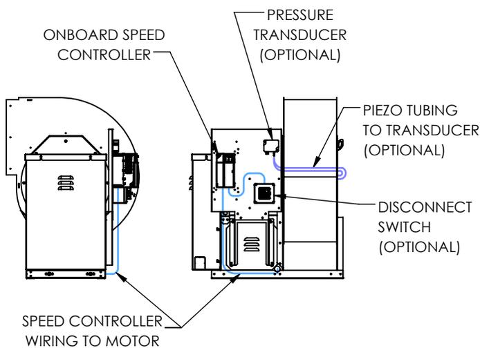
**ARRANGEMENT-10 WITH ONBOARD SPEED CONTROLLER**
